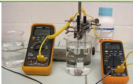
Schnellstarter: ALL-CHEM-MISST II Junior 2-Kanal oder... LowCost-Variante mit 2 Multimetern
