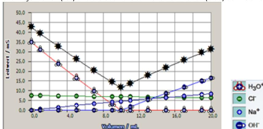
Die **Leitfähigkeit** fällt zunächst, weil die schnellen  $\text{H}_3\text{O}^+$ -Ionen durch langsamere  $\text{Na}^+$ -Ionen „ersetzt“ werden. Nach dem Äquivalenzpunkt steigt die Leitfähigkeit durch die etwas weniger beweglichen  $\text{OH}^-$ -Ionen wieder an. Der Äquivalenzpunkt ergibt sich aus dem Schnittpunkt der beiden Regressionsgeraden der zwei Phasen.
