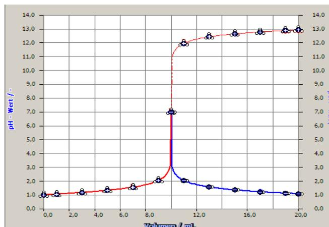
Zu Beginn ist der **pH-Wert** ist sehr niedrig, da die Chlorwasserstoffsäure vollständig dissoziiert ist. Im Laufe der Titration werden die Oxoniumionen durch die Hydroxidionen neutralisiert. In der Nähe des Äquivalenzpunktes aber steigt der pH-Wert bei weiterer Zugabe der Hydroxidionen sprunghaft an. Am Ende der Titration ist die Steigung wieder gering. Daher bietet sich hier die „3 Geradenmethode“ als Auswertemethode an.
